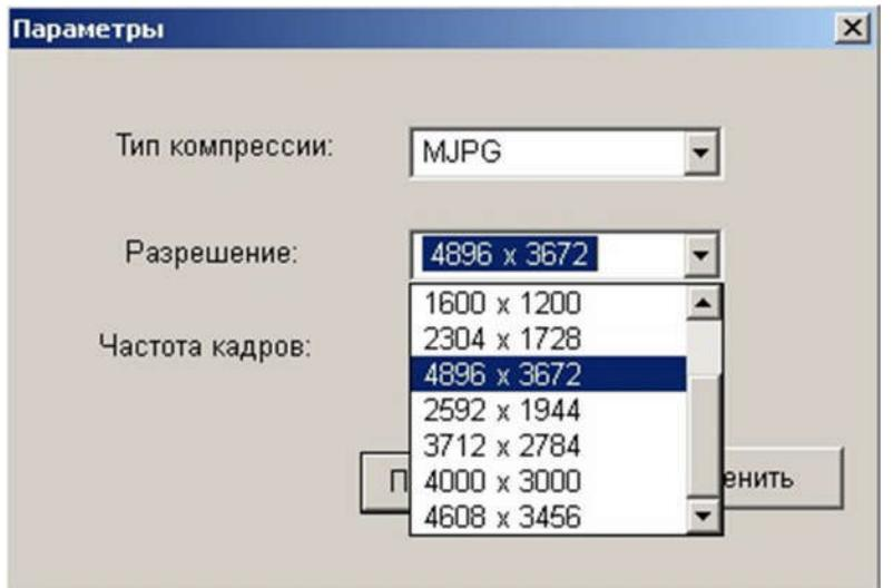
Важно отметить, что аппаратное разрешение сканера DOKO BS16 составляет 16M, что определяет разрешение изображений как 4608x3456 пикселей. Однако, за счет математической интерполяции удается поднять детализацию до 4896x3672 пикселей, что уже соответствует 18M. И по умолчанию в программе установлено именно это максимальное разрешение. Изменение разрешения в этом меню сохранит его установку для текущей и последующий сессий сканирования.
