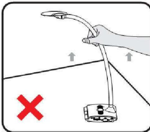
3. Будьте осторожны - камера может быть повреждена при ударе о поверхность стола или другой жесткий предмет.
