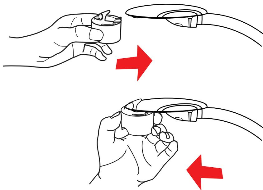
5. Закрепите головку камеры с установленным адаптером на окуляре микроскопа.
