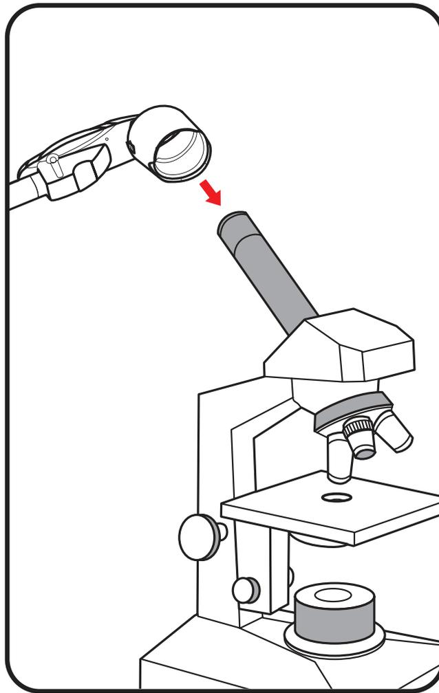
❗ Если изображение размыто, то сначала попробуйте подстроить фокус микроскопа, а затем нажмите кнопку автофокусировки на панели камеры.
