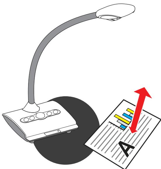
При высоте штатива 43 см достигается размер поля зрения А3
